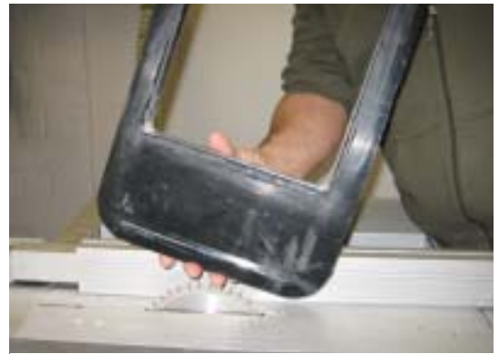
Ohne Spaltkeil an Kreissäge gearbeitet
