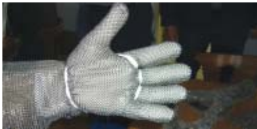
Für einen straffanliegenden Sitz des Kettenglieder-Handschuhs kann ein Fixiergummi verwendet werden. Dieser ist elastisch und behindert den Mitarbeiter nicht bei der Arbeit.
