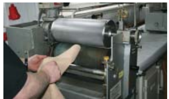
Abb. 2 Situation beim Reinigen – ohne Schutzvorrichtung
