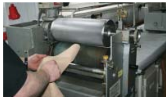
Abb. 2 Situation beim Reinigen – ohne Schutzvorrichtung
