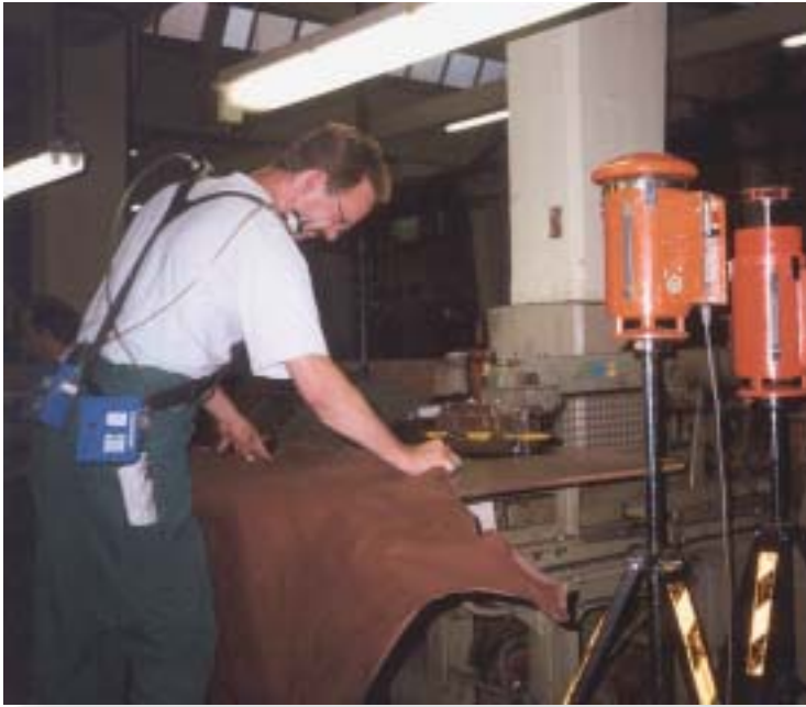
Abb. 1 Personenbezogene und stationäre Messung am Arbeitsplatz
